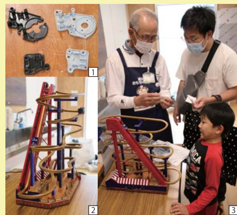
▲1：壊れた部品を3Dプリンタで復元 2：修理後のおもちゃ 3：修理方法の説明
