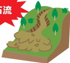
山腹の石・土砂が集中豪雨等によって一気に下流へ押し流される現象です。時速20~40キロという速度で、一瞬のうちに人家や畑等を壊滅させてしまいます。
