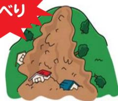
斜面の一部あるいは全部が地下水の影響と重力によって、ゆっくりと斜面下方に移動する現象です。土塊の移動量が大きいため、甚大な被害が発生することがあります。
