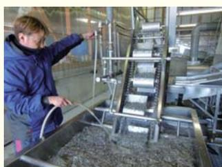
後、コンベアで次の茹で釜に運ぶ。U字型になった6列の茹で釜からはもうもうと湯気が立ち上り、
