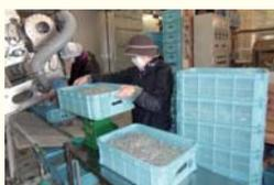
扇風機で粗熱を取りながら、シラスはコンベアで乾燥機に運ばれてゆく。5段になった乾燥機の中を折り返しながら、上から下へ15分ほど通ると、もうチリメンジャコの仕上げ。最後の選別機を経て、5キロずつ詰められたコンテナがたちまち山積みになる。わずか20分たらずの工程だ。
