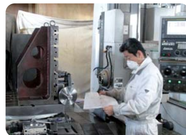
【NC横中ぐりフライス盤】 製品に穴を開ける装置
