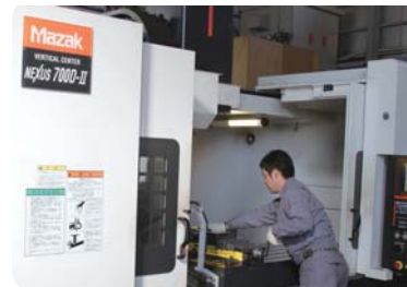
【マシニングセンター】 自動で多彩な製品を作成する装置
