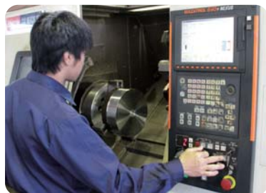
【CNC複合旋盤】 コンピュータ制御により鉄をさま ざまな形や穴を開ける装置
