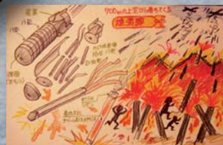
▲焼夷弾…筒の中に黄燐などの油脂が入っていて、それに火が付き燃焼する ひとつの爆弾にはこの筒が38本入っている
