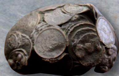
▲空襲時の熱で溶けて固まった硬貨 焼夷弾の熱量は1,000℃を超える
