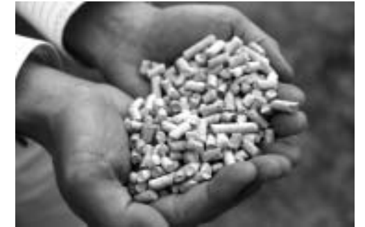
約15台の木質ペレットボイラーを購入予定。燃料となる「ペレット」は、間伐材を細かく砕いて加工したものである
