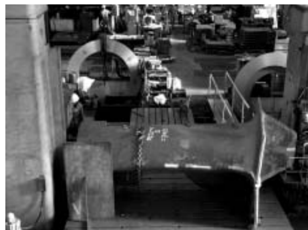
▲2台の横中グリ盤で同時に加工をしているところです
