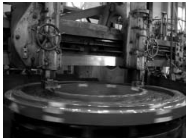
▲立旋盤で加工しているところです
