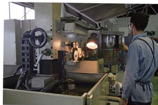
【ワイヤー放電加工】…ワイヤーに電力を流して金属を削っている
