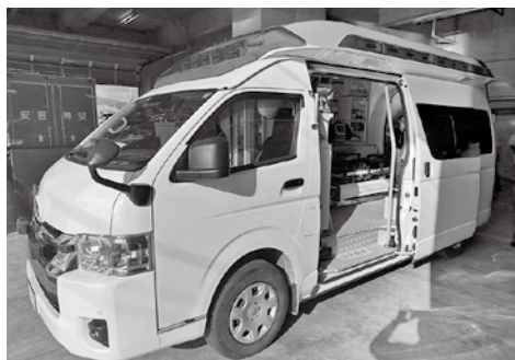
電動ストレッチャーを装備した高規格救急自動車
