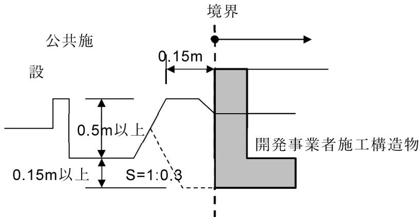
例—2) 農道等復旧を指導（良質土での埋め戻し）
